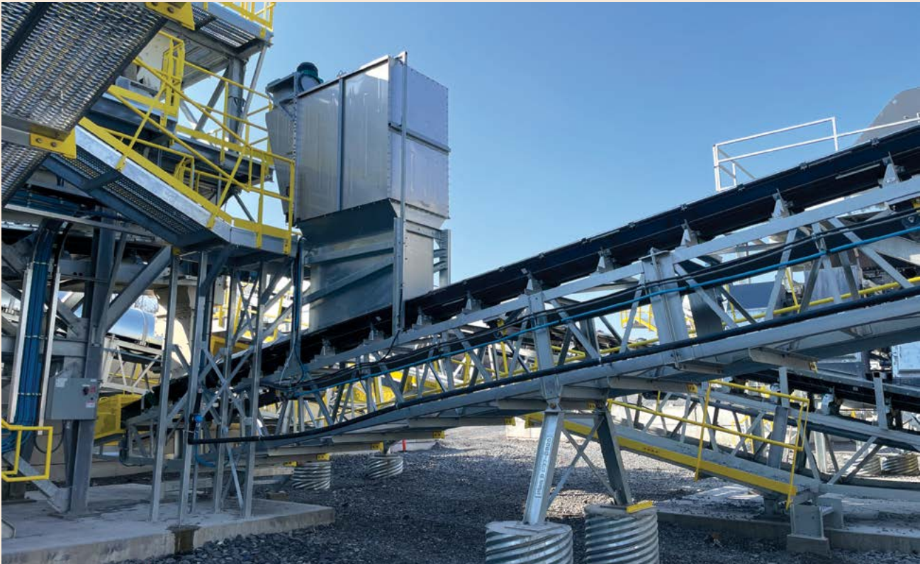
Brunone offre des équipements de confinement et d'aspiration de la poussière, qui s'adaptent aux convoyeurs.
